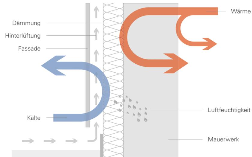
▲ System der VHF: Mit der konstruktiven Trennung von Wärmedämmung und Witterungsschutz sorgen vorgehängte hinterlüftete Fassaden für technische und wirtschaftliche Sicherheit und große Gestaltungsfreiheiten.
